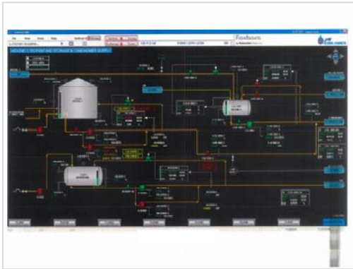
รูปที่ 71 สัญญาณเตือนระดับของสารเคมี บริเวณถังเก็บ และหน้าจอแสดงผล
