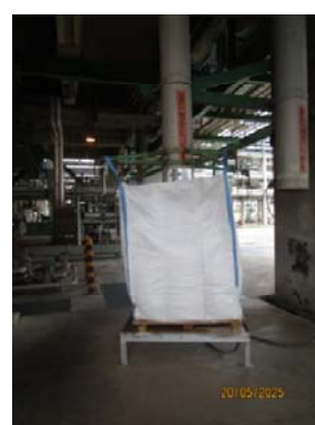
รูปที่ 28 ถุงบรรจุเศษพลาสติกขนาดเล็ก ที่ปะปนมากับน้ำเสียจากการตัดเม็ด
