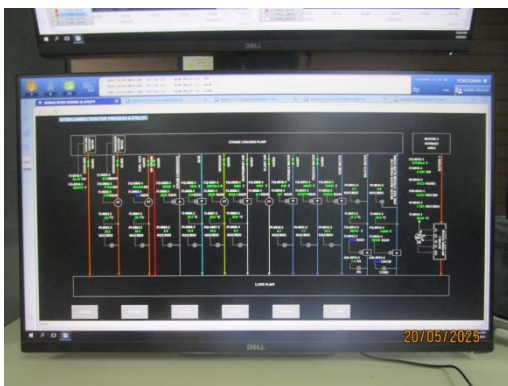
รูปที่ 67 หน้าจอควบคุมความดันและ อัตราการไหลของสารในท่อ
